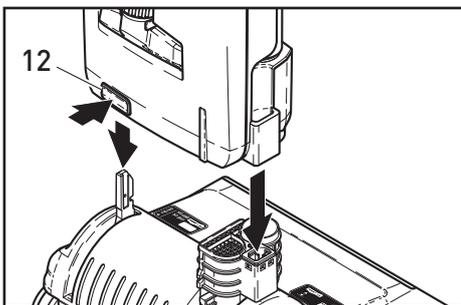
Zur Demontage die Entriegelungstaste(12) drücken und das Filtergehäuse(20) durch Ziehen von dem Gerätefuß(9) trennen.
