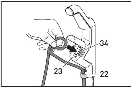
Führen Sie die Anschlussleitung anschließend in die Zuentlastung(23) ein, bis sie einrastet. Zum Wechsel der Anschlussleitung die Taste(34) neben der Zuentlastung drücken und das Kabel entsprechend wieder entnehmen. Das Teleskoprohr(7) erst in das Gelenk einführen und dann mit dem Griff(5) auf den Nocken(35) am Filtergehäuse stecken.
