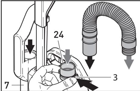
Die passende Schlauchseite in das Teleskoprohr(7) einführen. Zum Anschließen des Schlauches an das Filtergehäuse, das Ende mit der schwarzen Buchse in die Verbindungshülle (24) einführen und ganz einschieben. Durch Zusammendrücken der Griffflächen am Sicherungsring (3) kann der Schlauch wieder gelöst werden.
