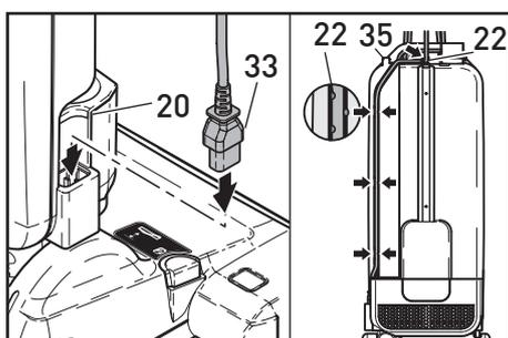
Den Stecker(33) der Anschlussleitung am Gelenk(21) einstecken. Hierbei unbedingt darauf achten, dass der Stecker hinter Kante(20) gehalten wird. Die Leitung anschließend an der Innenseite der Halterung für das Teleskoprohr und am Gehäuse in die vorgesehenen Halterungen(22) einlegen.
