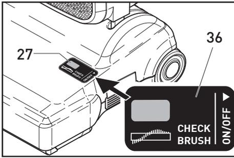
Ihr Bürststaubsauger ist mit einer Blockierungsanzeige(27) ausgestattet. Bei einer Blockade oder Überlastung der Bürste, wird das Gerät automatisch abgeschaltet und eine orangefarbene Anzeige erscheint im Display(36). Ziehen Sie in diesem Fall den Netzstecker und überprüfen Sie die Bürste auf Verunreinigungen.
