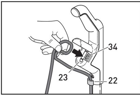
Führen Sie die Anschlussleitung anschließend in die Zugentlastung(23) ein, bis sie einrastet. Zum Wechsel der Anschlussleitung die Taste(34) neben der Zugentlastung drücken und das Kabel entsprechend wieder entnehmen. Das Teleskoprohr(7) erst in das Gelenk einführen und dann mit dem Griff(5) auf den Nocken(35) am Filtergehäuse stecken.
